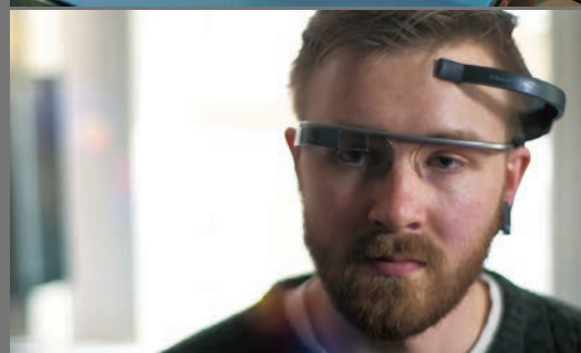
TNDL 마인드 리딩 타이어의 뇌파 감지 헤드셋(위), 오빗(가운데)은 EEG 헤드셋이 뇌파를 감지해 블루투스 방식으로 모바일 디바이스에 전달한다. 소프트웨어는 실시간으로 뇌파를 분석 및 시각화해 적외선 어댑터를 통해 헬리콥터에 명령을 내린다. 구글 글라스와 연동되는 마인드RDR(아래)은 오빗과 마찬가지로 EEG 헤드셋을 통해 뇌파를 감지한다.
