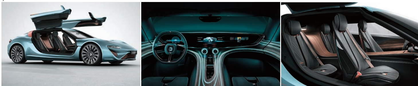
열핏 2인승으로 보이지만 길이가 5.2m에 달하는 4인승 길형 타입 쿠페로, 400ℓ의 전해액을 채우면 600km 이상 달릴 수 있다. 총 925마력의 전기모터로 발휘하는 가속 성능이나 최고 속도가 슈퍼카 뺨칠 정도다.
