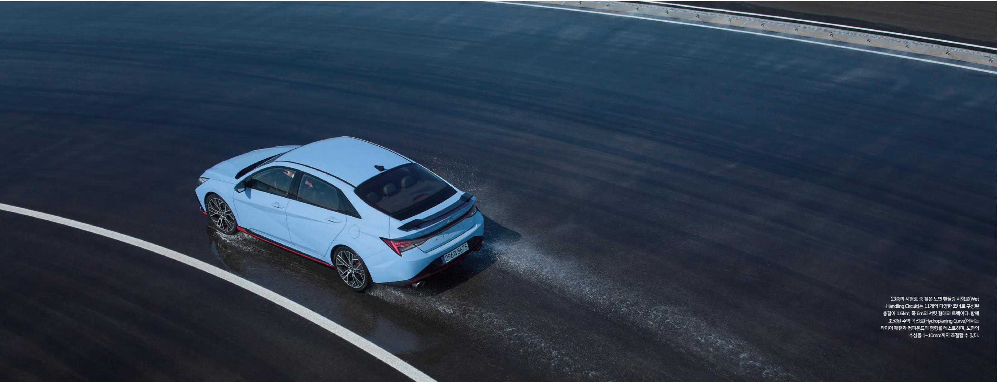
13종의 시험로 중 젖은 노면 핸들링 시험로(Wet Handling Circuit)는 11개의 다양한 코너로 구성된 총길이 1.6km, 폭 6m의 서킷 형태의 트랙이다. 함께 조성된 수막 곡선로(Hydroplaning Curve)에서는 타이어 패턴과 컴파운드의 영향을 테스트하며, 노면의 수심을 1~10mm까지 조절할 수 있다.
