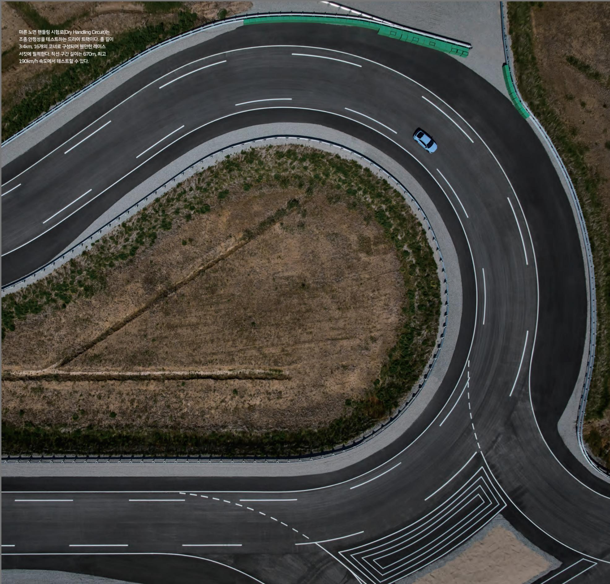
1 마른 노면 핸들링 시험로 안쪽에는 그레블 로드(Gravel Road)가 조성됐다. 날카로운 돌이 많은 도로를 주행하거나 예리한 급속 등의 이물질로 타이어가 손상되는 현상에 대한 테스트를 진행한다. 2 장애물로(Off Road)에는 비포장도로와 물웅덩이, 언덕, 바위 등의 장애물을 설치해 험로 및 오프로드 주행 테스트를 진행할 수 있다. 3 통과 소음 시험로(Pass by Noise)는 완성차 제조사 및 ISO 국제 인증 테스트를 수행하기 위한 인증 노면을 두 개 건설해 동시에 복수의 테스트를 진행할 수 있다. 4 소음 시험로(Noise Vibration Harshness)에서는 다양한 노면에서 타이어가 마찰할 때 발생하는 소음을 평가한다. 총 길이 700m, 5개 차로에 종류가 다른 7개의 노면-아스팔트 및 콘크리트 포장-으로 구성됐다.
